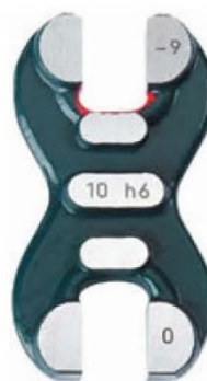
Слика 1.2.1.2. Двострана контролна рачва
