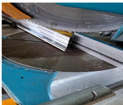
Слика 4.1.2.12. Сјечење радних елемената од ALU профила
