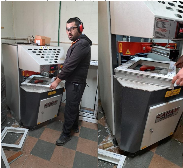
Слика 4.1.2.6. Чишћење заварених спојева на PVC профилима
