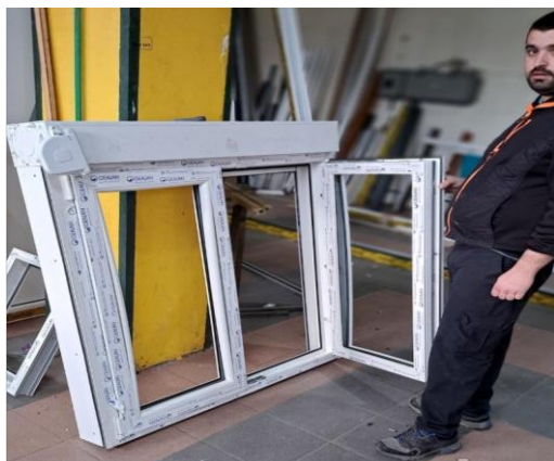
Слика 4.1.2.9. PVC прозор у завршној изради у радионици (стакла се уграђују на мјесту монтаже)
