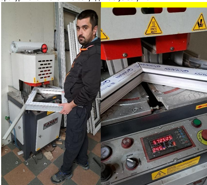
Слика 4.1.2.5. Спајање углова PVC профила
