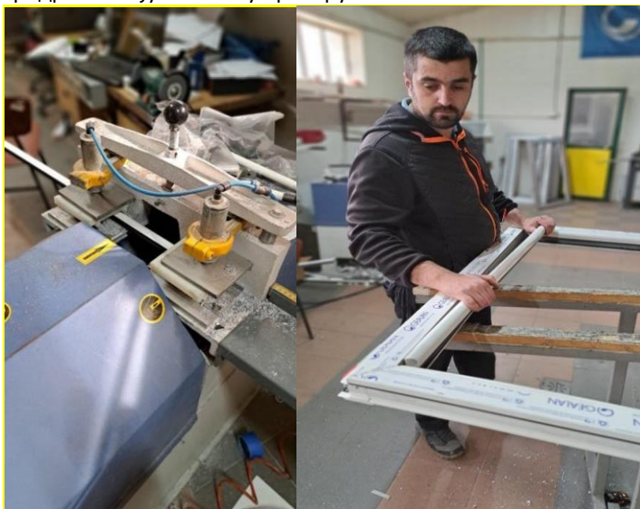
Слика 4.1.2.7. Сјечење лајсне (слике лево) и монтажа лајсне у крило PVC прозора (слика десно)
