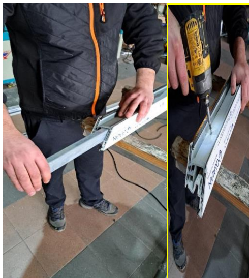
Слика 4.1.2.4. Уградња ојачања PVC профила (слике лијево) и његова веза са PVC профилем (слика десно)
