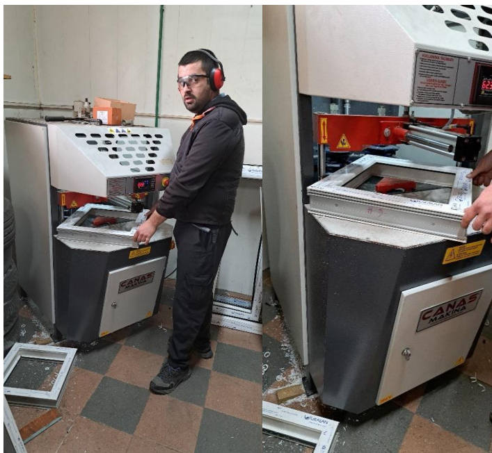
Slika 4.1.2.6. Čišćenje zavarenih spojeva na PVC profilima
