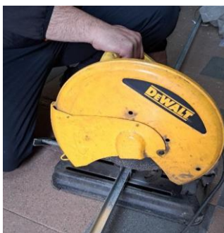
Slika 4.1.2.3. Sječenje ojačanja PVC profila
