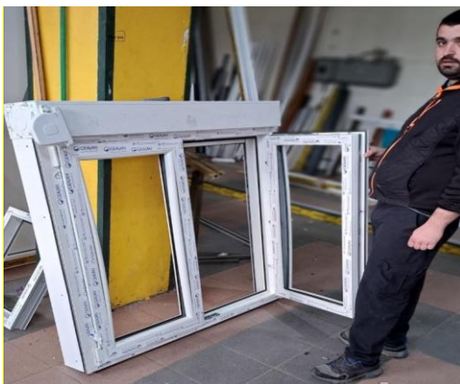
Slika 4.1.2.9. PVC prozor u završnoj izradi u radionici (stakla se ugrađuju na mjestu montaže)
