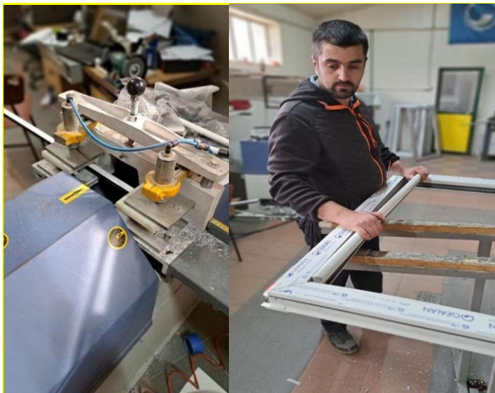
Slika 4.1.2.7. Sječenje lajsne (slike lijevo) i montaža lajsne u krilo PVC prozora (slika desno)
