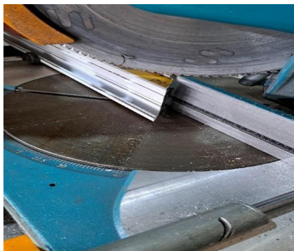
Slika 4.1.2.12. Sječenje radnih elemenata od ALU profila
