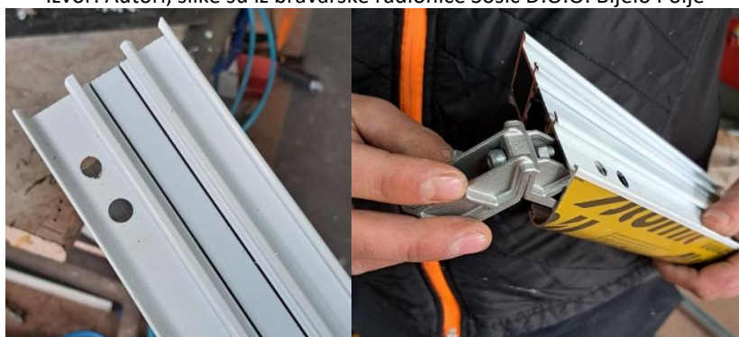
Slika 4.1.2.14. Otvori na ALU profilu predviđeni za montiranje spojnice (slika lijevo) i montaža spojnice u ALU profil (slika desno)
