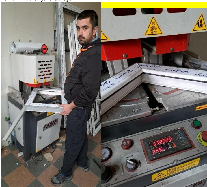
Slika 4.1.2.5. Spajanje kutova PVC profila
