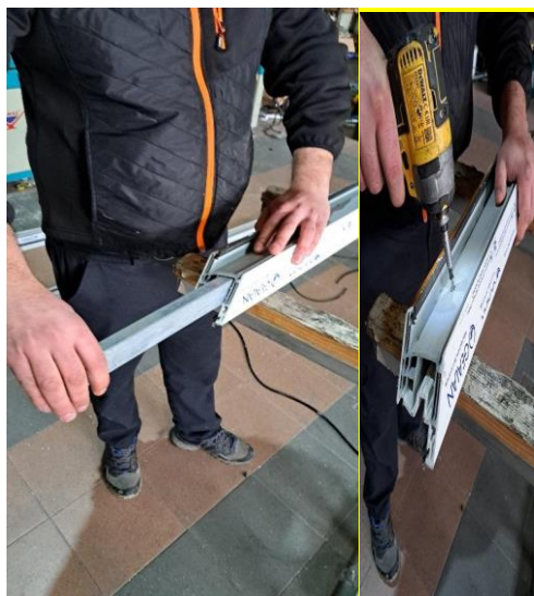
Slika 4.1.2.4. Ugradnja ojačanja PVC profila (slike lijevo) i njegova veza s PVC profilom (slika desno)
