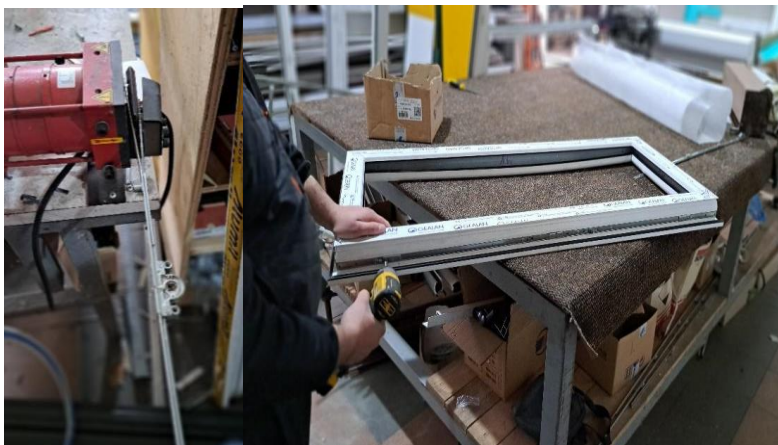
Slika 4.1.2.8. Sječenje okretno-nagibnog mehanizma za otvaranje prozora (slike lijevo) i njegova montaža (slika desno)
