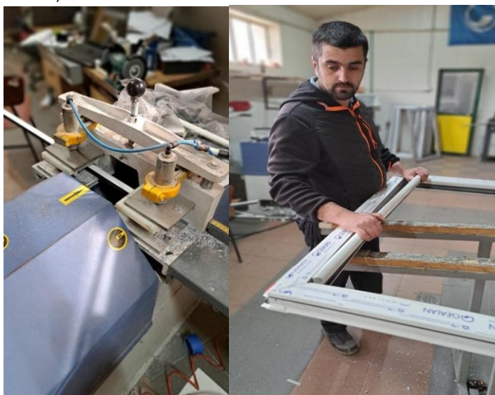
Slika 4.1.2.7. Sečenje lajsne (slike levo) i montaža lajsne u krilo PVC prozora (slika desno) Izvor: Autori, slike su iz bravarske radionice Sošić D.O.O. "Bijelo Polje"
