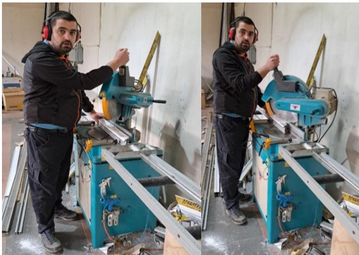
Slika 4.1.2.2. Sječenje PVC profila, sa različitim uglovima od 45°
