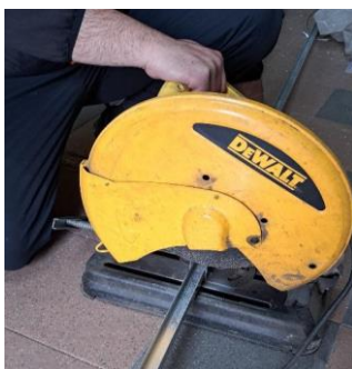
Slika 4.1.2.3. Sječenje ojačanja PVC profila
