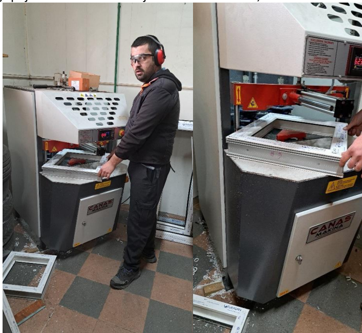
Slika 4.1.2.6. Čišćenje zavarenih spojeva na PVC profilima Izvor: Autori, slike su iz bravarske radionice Sošić D.O.O. "Bijelo Polje"
