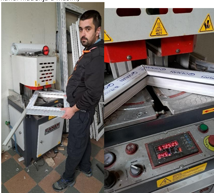
Slika 4.1.2.5. Spajanje uglova PVC profila
