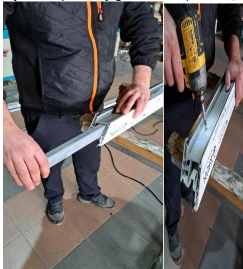
Slika 4.1.2.4. Ugradnja ojačanja PVC profila (slike lijevo) i njegova veza sa PVC profilom (slika desno)
