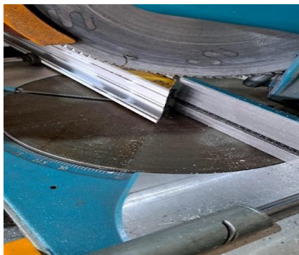
Slika 4.1.2.12. Sječenje radnih elemenata od ALU profila
